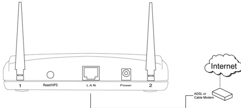
2. Schließen Sie alle Computer, Netzwerkgeräte (netzwerkfähige Geräte, außer Computern, wie Spielkonsole oder Switch/Hub) an den LAN-Anschluss des Routers an.
