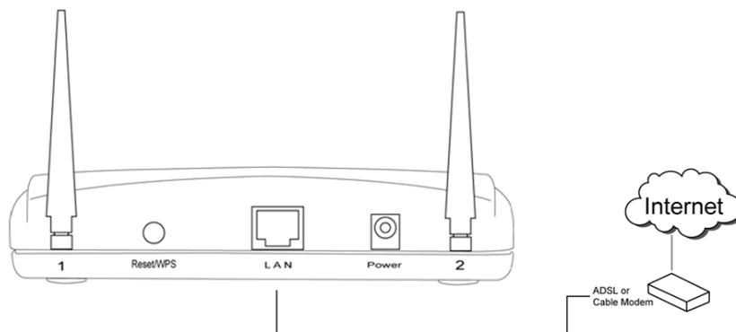
3. Schließen Sie den Netzadapter an die Steckdose an und verbinden Sie ihn dann mit der "Power"-Buchse des Routers.
